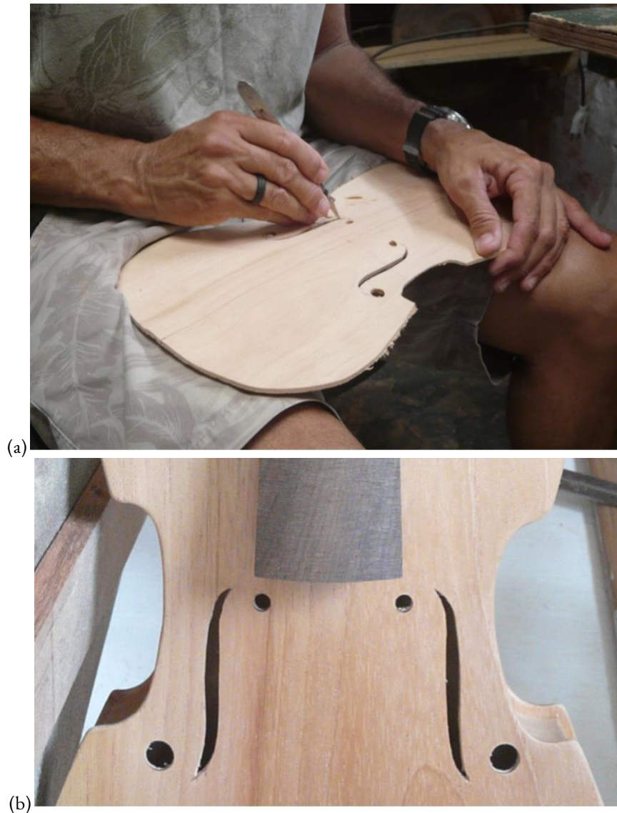
FIGURA 14 – (a) Usando um bisturi com lâmina 11, Bizunga dá acabamento aos efes; (b) na imagem podemos ver os efes finalizados num instrumento recente de Bizunga.
