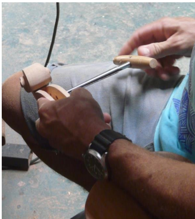
FIGURA 28 – O alargador é usado para aprimorar as superfícies dos furos da caixa das cravelhas.
