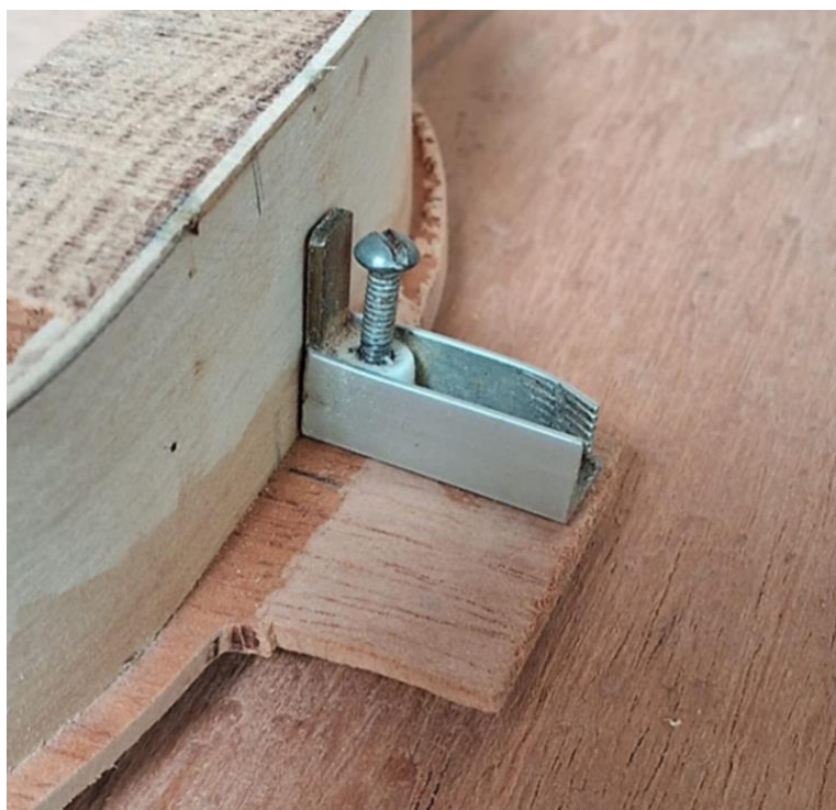
FIGURA 6c – Espaçador, acima da área da nocetta , na posição de uso (num instrumento com o fundo já cortado).
