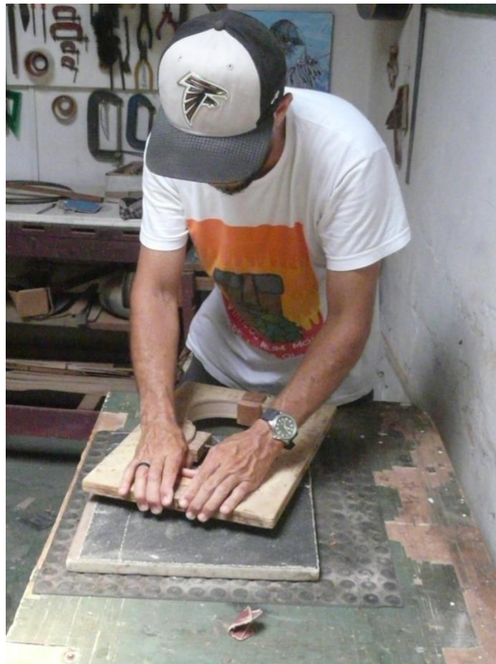
FIGURA 3 – Bizunga lixa as áreas das laterais que ficarão em contato com o tampo e o fundo.
