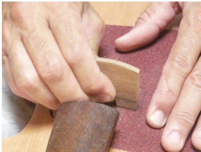
FIGURA 32 – Usando uma lixa acima do tampo, o construtor ajusta a forma dos pés do cavalete à curvatura do tampo na área onde a peça deverá ficar posicionada.
