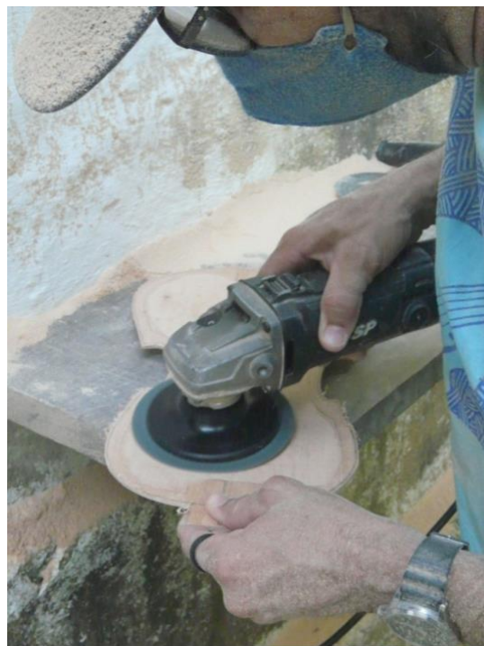
FIGURA 9 – Escavação da parte interna do fundo. A linha desenhada usando as laterais sinaliza o limite da área côncava.
