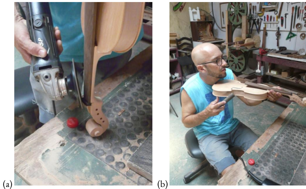
FIGURA 26 – (a) A forma da pestana é elaborada usando a esmerilhadeira; (b) Bizunga lima a pestana e confere a que a forma da peça seja a adequada.
