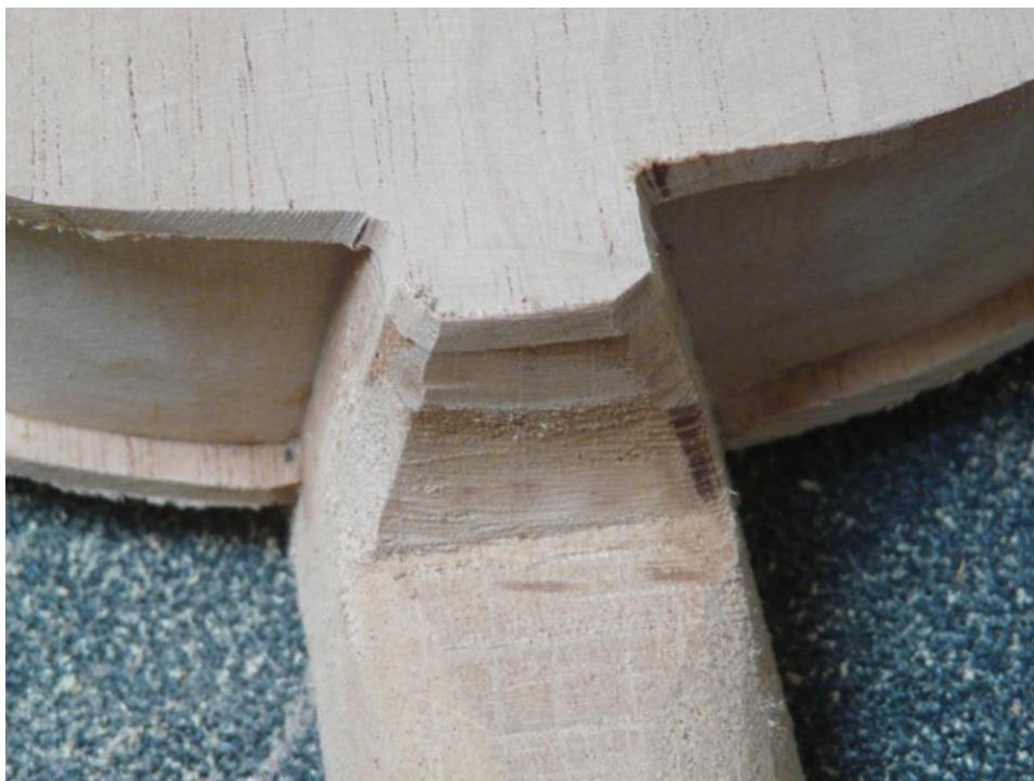
FIGURA 20 – O material excedente da nocetta é removido para adaptar a seção à forma da parte posterior da base do braço. Mais adiante a nocetta será lixada até alcançar seu formato final.
