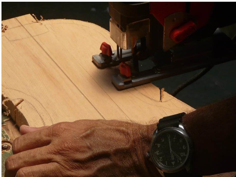
FIGURA 7 – O fundo é cortado usando a serra tico-tico. A área reservada para a nocetta e visível na parte superior esquerda da imagem.
