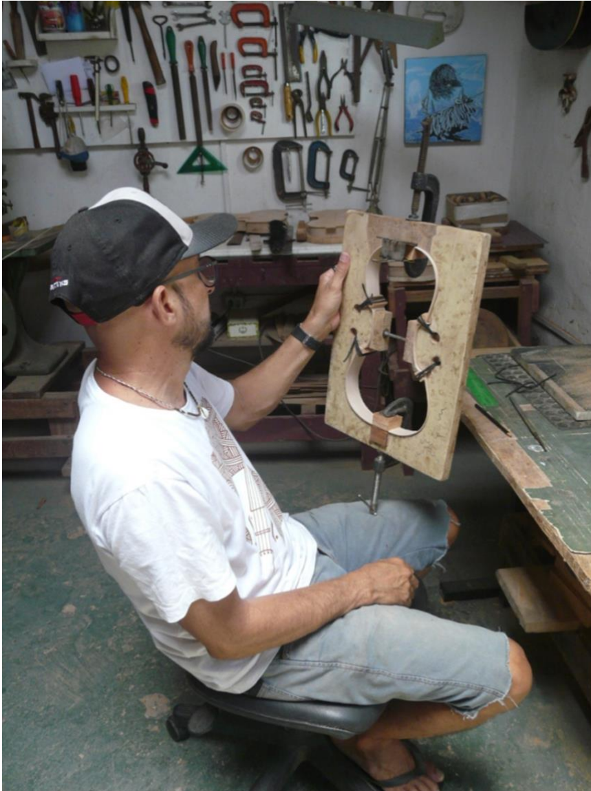
FIGURA 2 – Bizunga confere que os blocos e bloquinhos estejam bem segurados com os sargentos e as tiras de borracha.
