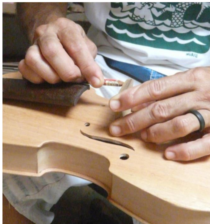
FIGURA 33 – Usando um lápis, apoiado no espelho, Bizunga transfere a curvatura desta peça para o cavalete, o qual está colocado acima do tampo na sua posição final.
