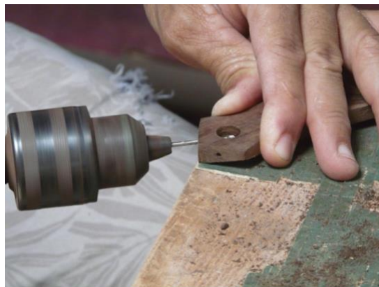
FIGURA 25 – O estandarte recebe três furos que permitirão a instalação do rabicho.
