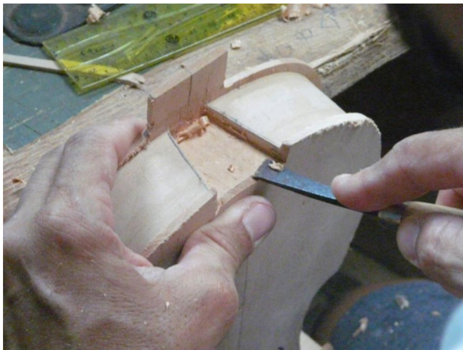
FIGURA 19 – Bizunga trabalha no entalhe usando um formão.
