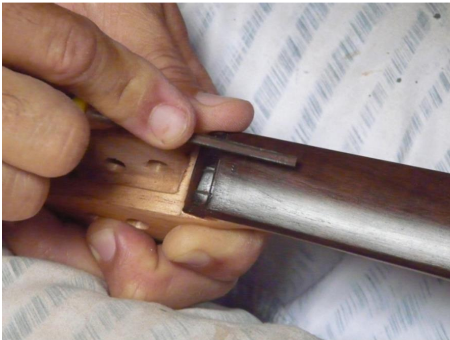
FIGURA 34 – Bizunga utiliza uma lima triangular para abrir os sulcos na pestana que receberão as cordas.
