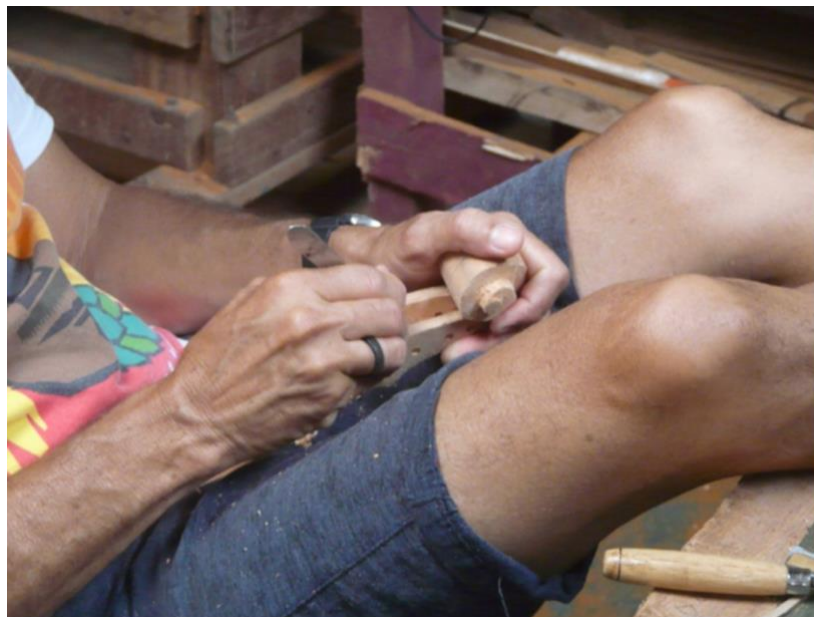
FIGURA 12c–Bizunga trabalha na caixa das cravelhas usando um bisturi.
