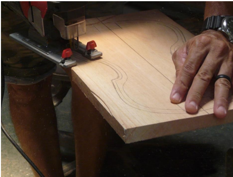
FIGURA 13 – Bizunga corta o tampo usando a serra tico-tico. Vejam-se as linhas que delimitam os locais a serem escavados.
