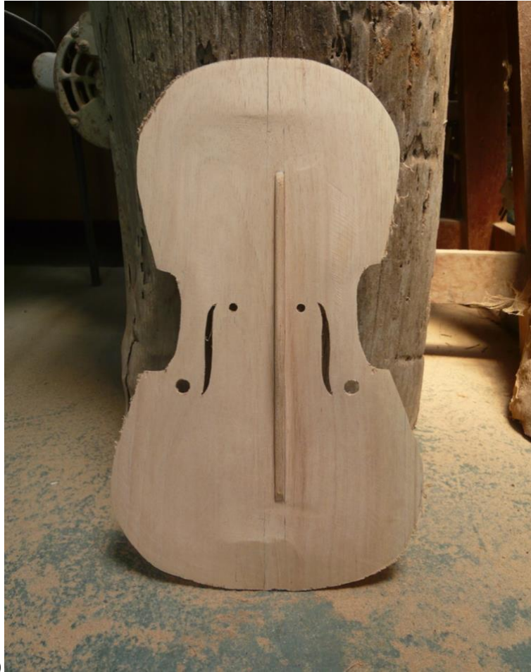
FIGURA 16 – A barra harmônica: (a) vista superior; (b) vista lateral.
