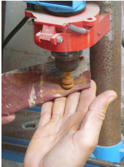
FIGURA 31 – O botão é colocado na furadeira vertical onde, usando lixa, a cabeça da peça é moldada.
