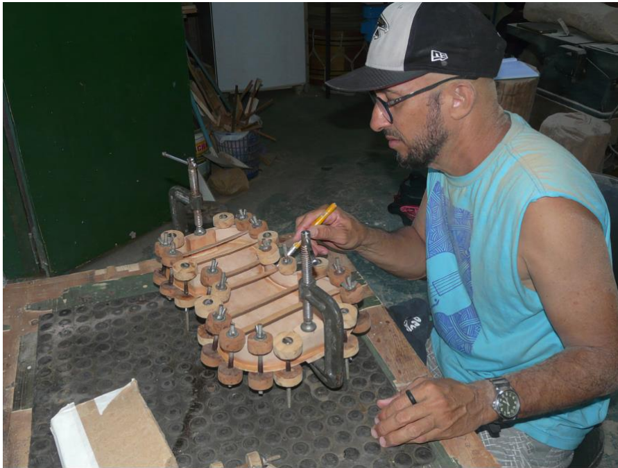
FIGURA 10 – Bizunga remove qualquer excesso de cola usando um pincel.
