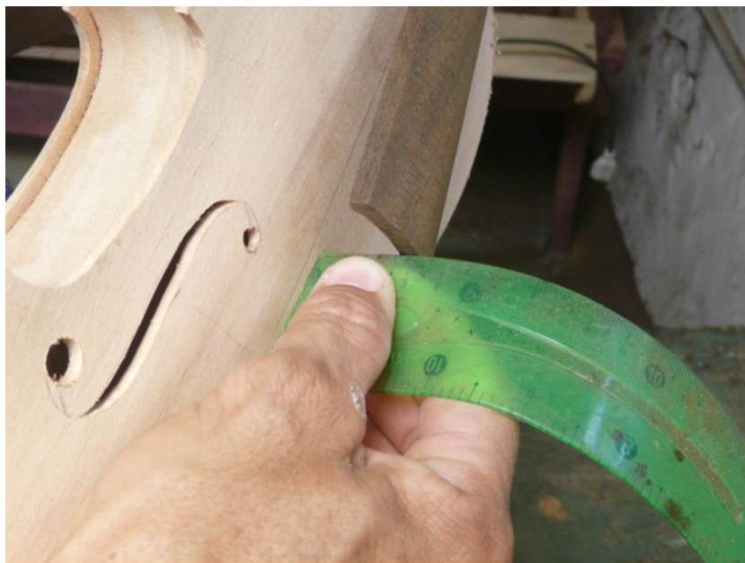
FIGURA 23 – Bizunga confere a medida entre a superfície do espelho e o tampo.
