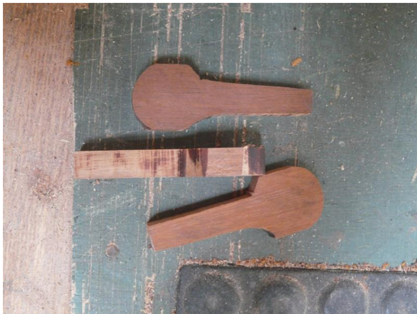
FIGURA 27 – As cravelhas na fase inicial do processo de construção.
