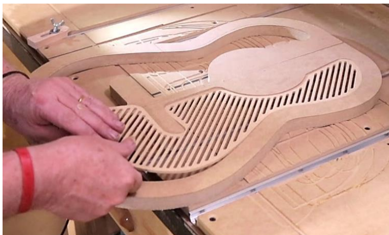
FIGURA 7– Elaboración de rejilla interior de madera balsa para guitarra double-top .
