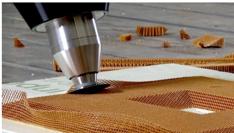
FIGURA 2 – Panal de nómex 2 cortado con una herramienta de ultrasonido. Breton Institute of Technologie.
