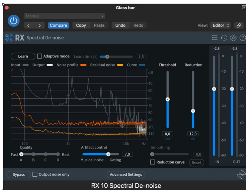
FIGURA 16 – Utilização de plugin para mitigação de ruídos na captação dos sons da barra de vidro
