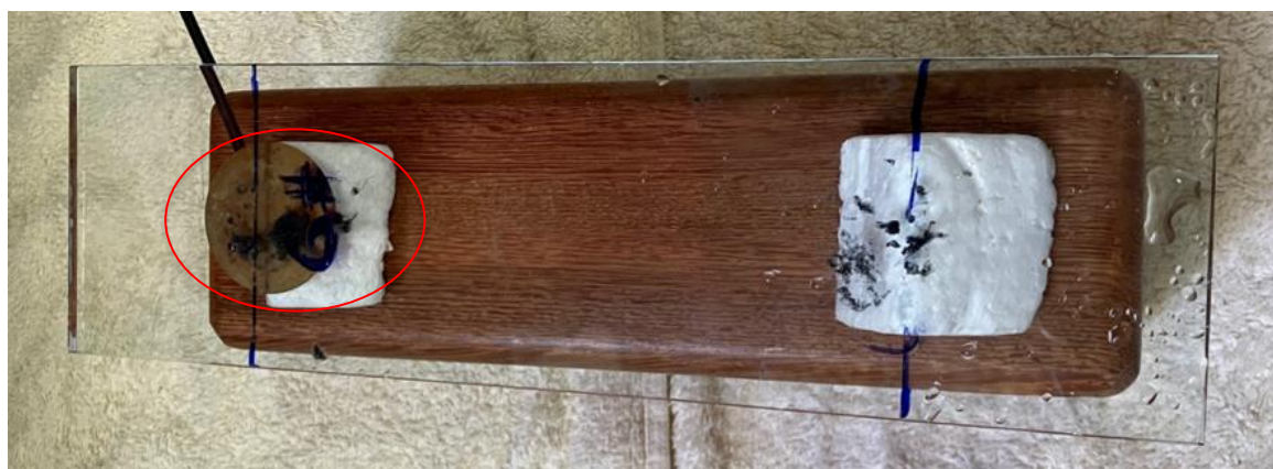
FIGURA 15 – Barra de vidro suspensa 29 sobre peças de isopor em seus pontos nodais, com o piezo elétrico em contato com o ponto nodal na extremidade oposta ao impacto das gotas d'água
