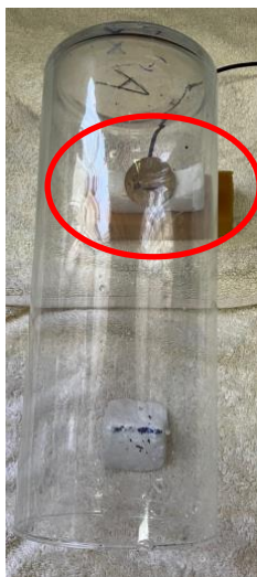
FIGURA 11 – Detalhe do piezo elétrico acoplado ao tubo de vidro
