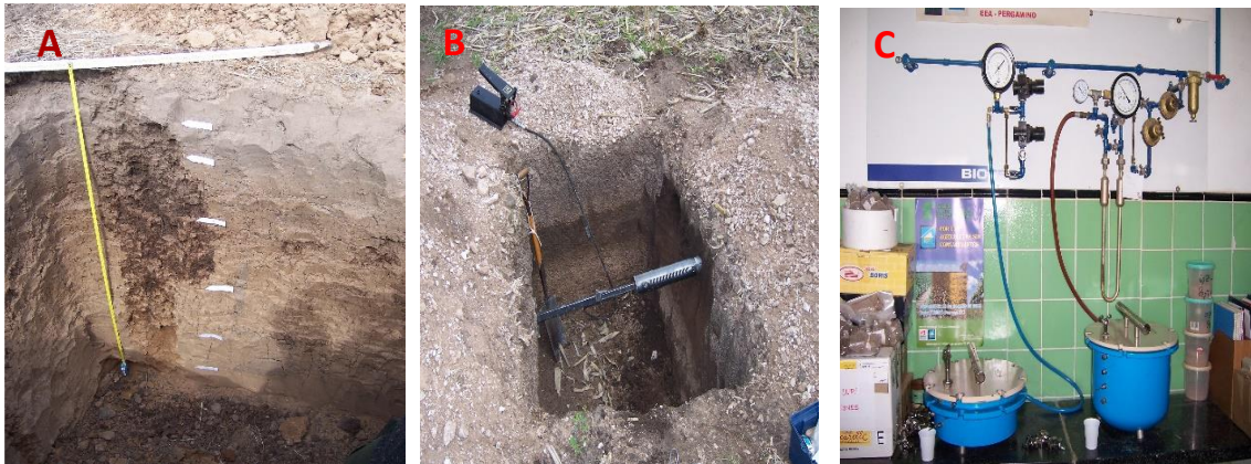
Figura 1: Calicata con la identificación de los horizontes (A); Extracción de cilindros mediante una prensa hidráulica o calador manual para densidad aparente de cada horizonte (B); Determinación en laboratorio de capacidad de retención y PMP (C).
