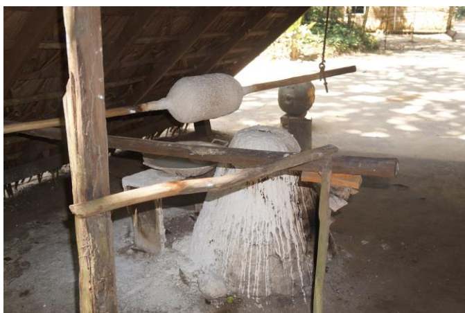
Figura 4: Processo de defumação da borracha.vFonte: Figura selecionada pelos pesquisadores a partir da coleta de dados.
